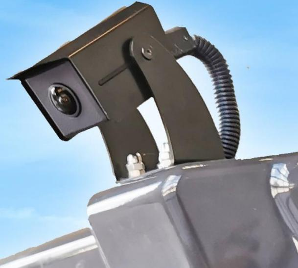
Der **CarEye® Rearview Assistant** bildet ein zusätzliches Hilfsmittel für das Fahrpersonal beim Rangieren (Rückwärtsfahren) von Nutzfahrzeugen bis zu 10 km/h und wird bei Einlegen des Retourganges per CAN-Signal an die zentrale Steuereinheit (TIC-Box) aktiviert.
